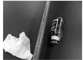
【資料6 塩化銅水溶液ゼリー入りのストロー実験の写真】
